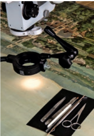
Unter dem Operationsmikroskop werden die gerissenen Fäden geordnet, plziert, planiert und fixiert. Danach werden die getrennten Fadenenden wieder miteinander verklebt.
